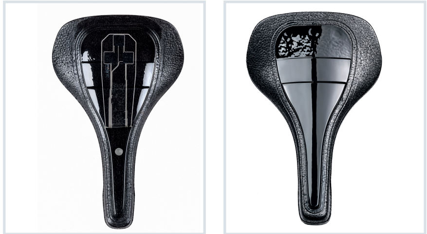
Bild 7. Technologiedemonstrator EPP-Sattel: funktionalisiert mit einer gedruckten Schaltung und überflutet mit Klarlack zur Untersuchung der Tiefenwirkung (links); überflutet mit „pianoblack“-PUR (rechts) in unterschiedlichen Schichtdicken (0,5 mm, 1,5 mm, 2,5 mm), um die Farbintensität zu verdeutlichen (© ThiM-Netzwerk)
