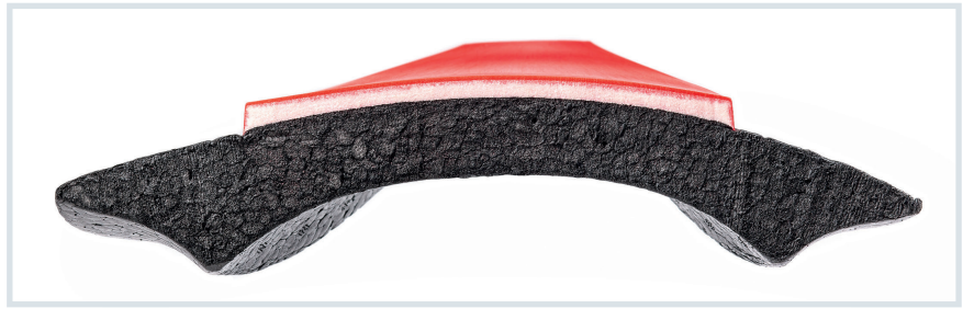
Bild 6. Nach einer Vorbehandlung mit Plasma lässt sich EPP mit einem Halbhart-Schaum überfluten, der bei diesem Muster mit einem weiteren PUR-System überflutet wurde (© ThiM-Netzwerk)
